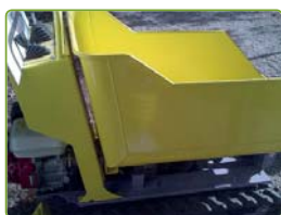
Стальной кузов, усиленная толщина кузова 3 мм.
